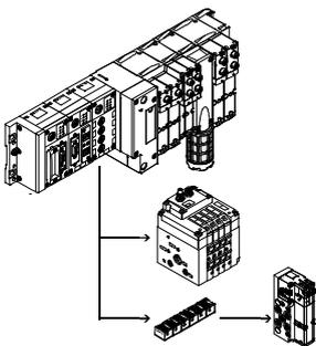
Die optionale CP-Strangerweiterung bietet die Möglichkeit, an bis zu 4 CP-Stränge weitere Ventilinseln und E/A-Module an den Feldbusknoten des CPX-Terminals anzuschließen. Es können verschiedene Ein- und Ausgangsmodule sowie MPA-S und CPV-Ventilinseln angeschlossen werden. Die maximale Länge der
