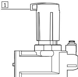
Nach erfolgter Druckeinstellung kann der Drehknopf gegen unbefugte Betätigung gesichert werden.
