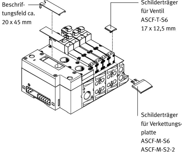
Zur Kennzeichnung der Ventile und der Verkettungsplatten können Schilderträger montiert werden. Über Code B bzw. T im Bestellcode Zubehör können diese gleich mitbestellt werden. Lieferumfang: Schilderträger inklusive Bezeichnungsschild.
