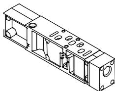
Mit dieser Platte kann ein Ventil unabhängig vom Betriebsdruck der Ventilinsel mit individuellem Betriebsdruck versorgt werden.
