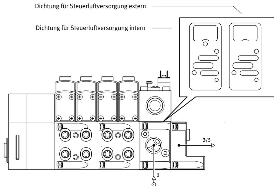
1) Bei dieser Konstellation ist eine rechte Endplatte mit Codierdeckel nicht möglich, da hierüber keine Abluft abgeführt werden kann
