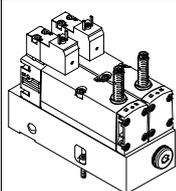
2 x 5/2 Wege-Magnetventil monostabil, Rückstellung über mechanische Feder, mit Schaltstellungsabfrage über induktiven Sensor und 3-poligem Sensor-Steckanschluss M8, montiert auf Zwischenplatte zur pneumatischen Verkettung | SP <sup>2)</sup> | PNP           | 53             | 1112        | – <sup>1)</sup> | <b>VOFA-B26-T52-M-1C1-APP</b> |
