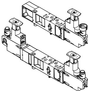
Für die Beeinflussung der Kraft des angesteuerten Aktuators kann zwischen Grundplatte (Verkeftungplatte) und Ventil ein einstellbares Druckregelventil eingebaut werden.
