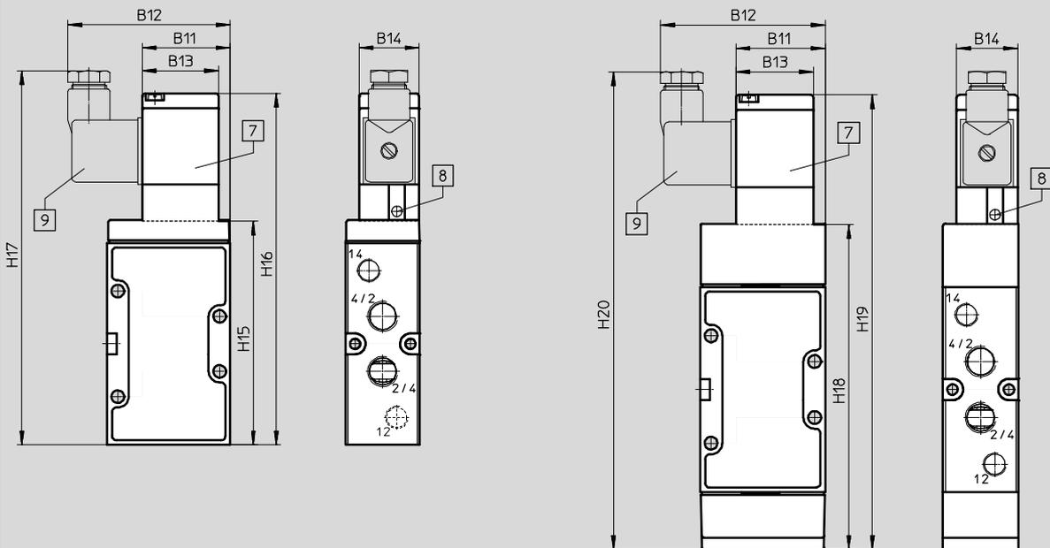
7 Magnetspule um 180° umsetzbar
