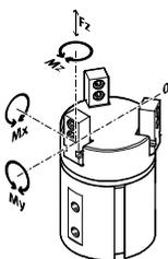
Die angegebenen zulässigen Kräfte und Momente beziehen sich auf einen Greifbacken. Sie beinhalten den Hebelarm, zusätzliche Gewichtskräfte durch das Werkstück bzw. durch externe Greiffinger und auftre-
