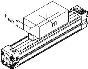
Die Dämpfung in den Endlagen ist so einzustellen, dass ein stoßfreier Betrieb gewährleistet ist. Liegen die Betriebsbedingungen außerhalb des zulässigen Berei-
