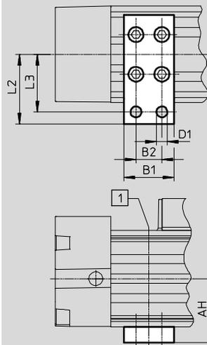
1) Position der Mittenstütze im Bereich des Profilrohrs frei wählbar
