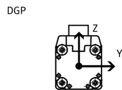
Wirken gleichzeitig mehrere der unten genannten Kräfte und Momente auf den Antrieb, müssen neben den aufgeführten Maximalbelastungen folgende Gleichungen erfüllt werden:
