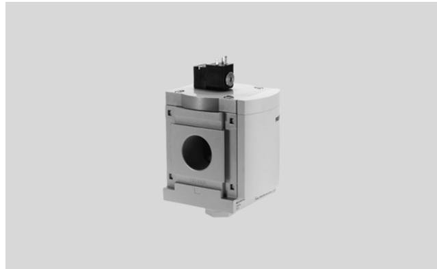
用阀盖上的限制器来调节增压时间。输出压力 p2 按限制器设置缓慢上升。电磁阀未驱动时，仅可用限制器给的供气。通过给电磁阀通电才能打开主阀座。
