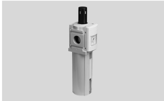
该设备为过滤器和减压阀组成的一个单元。烧结式过滤器带水分分离器，去除压缩空气中的脏污、管屑、锈和冷凝水。
