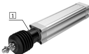
Le kit de soufflet est un système hermétique. Pour éviter l'aspiration de substances parasites, l'air d'alimentation et d'échappement du kit est collecté via un orifice de compensation de pression dans l'élément de liaison **1**.
