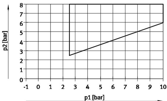
Este diagrama es válido para válvulas de 2x3/2 vías y válvulas monoestables de 5/2 vías con resorte neumático:
