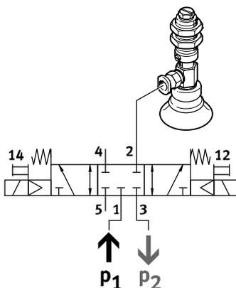
Con aire de pilotaje interno, es posible combinar vacío, impulso de expulsión y posición de reposo.
