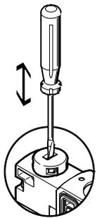
El accionamiento manual auxiliar se acciona presionando con el pasador o con el destornillador y regresa a su posición mediante reposición por muelle (la posición bloqueada se evita mediante la tapa ciega codificada).
