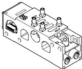
La adaptación al ancho de 65 mm y tamaño ISO 3 se basa en un sistema modular compuesto de placas base y válvulas. Las placas de enlace tienen un canal con junta y un módulo distribuidor eléctrico, están unidas entre sí mediante tornillos y forman el sistema portante para las válvulas.
