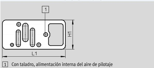
1 Con taladro, alimentación interna del aire de pilotaje
