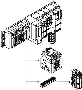
Con la ampliación opcional del ramal CP es posible conectar a 4 ramales CP más terminales de válvulas y módulos E/S al nodo de bus de campo del CPX. Es posible conectar diversos módulos de E/S y terminales de válvulas CPV-SC y CPV. La longitud máxima del ramal de
