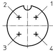
1 Conector tipo clavija M12x1, 4 contactos según EN 61076-2-101
