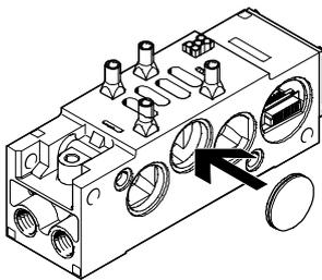
Si se montan discos de aislamiento entre dos placas de alimentación, es posible utilizar presiones de alimentación diferentes, dentro del margen definido por las válvulas de 65 mm de ancho. En ese caso debe tenerse en
