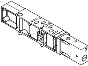
Equipada con un conmutador para bloquear la alimentación de presión. De esta manera es posible sustituir una electroválvula distribuidora o una placa posterior sin desconectar el aire de alimentación. Si la cadena de control es redundante, el ciclo puede continuar funcionando si el control es monocíclico.
