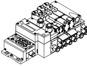
La transmisión de datos a un PLC de nivel superior está a cargo de un nodo de bus de campo. De esta manera, es posible obtener una solución compacta en las partes neumática y electrónica.
