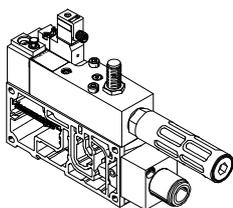
La válvula de arranque progresivo se activa eléctricamente por separado a través de un conector tipo clavija de 4 contactos según norma ISO 15407-1 u, opcionalmente, con un adaptador M12, independientemente de la conexión de multipolo, AS-Interface o bus de campo. Opcionalmente se puede pedir la válvula con un sensor que controla la
