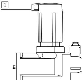
Una vez realizado el ajuste de la presión puede volver a bloquearse el botón giratorio para evitar un accionamiento no autorizado. Para ello se extrae hacia fuera la pieza azul y se bloquea con un candado. Ahora el botón giratorio está cerrado y ya no puede moverse.
