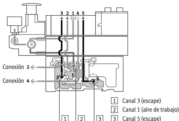
Este regulador de presión regula la presión en el canal 1, delante de la válvula. De esta manera, los canales 2 y 4 tienen la misma presión regulada.
