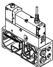
La válvula de conexión de aire de pilotaje es una combinación de una electroválvula de 5/2 vías con detección de la posición de conmutación y una placa intermedia VABF-S4-...-S. Esta válvula permite abrir el paso de la alimentación de aire de pilotaje desde el canal 1 hacia el canal 14 de manera comprobable
