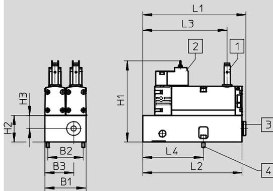
1 Sensor de posición PNP o NPN, tamaño M8x1, conexión según EN 61076-2-104
