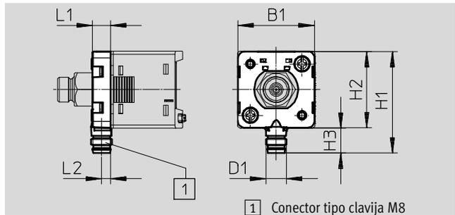
1) Conector tipo clavija M8
