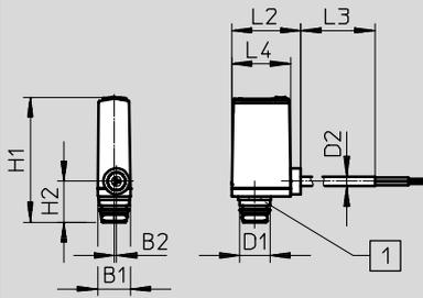
1 Conexión tipo clavija
