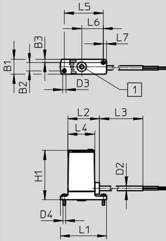
1 Conexión de presión con junta tórica para montaje plano para SPAE-F
