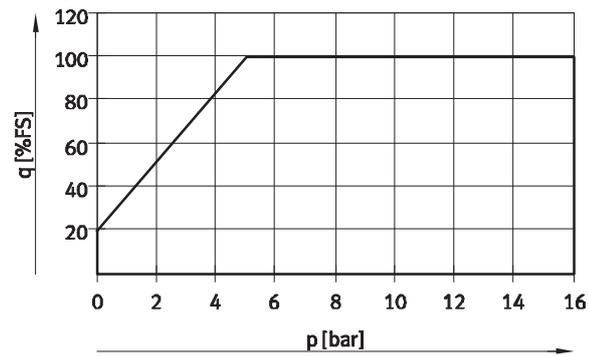
1) A partir de una presión de funcionamiento de 5 bar, el sensor de caudal ofrece valores de medición de acuerdo con la precisión especificada en todo el margen de medición. Como se puede apreciar en el diagrama, si la presión de funcionamiento es inferior a 5 bar, disminuye el margen de medición en el que los valores medidos corresponden a la precisión especificada.
