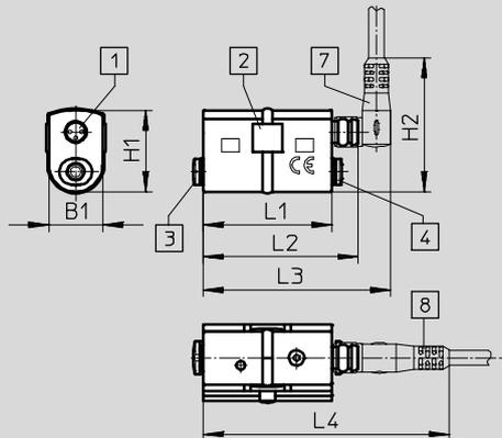
SDE5 con elemento para montaje en la pared
