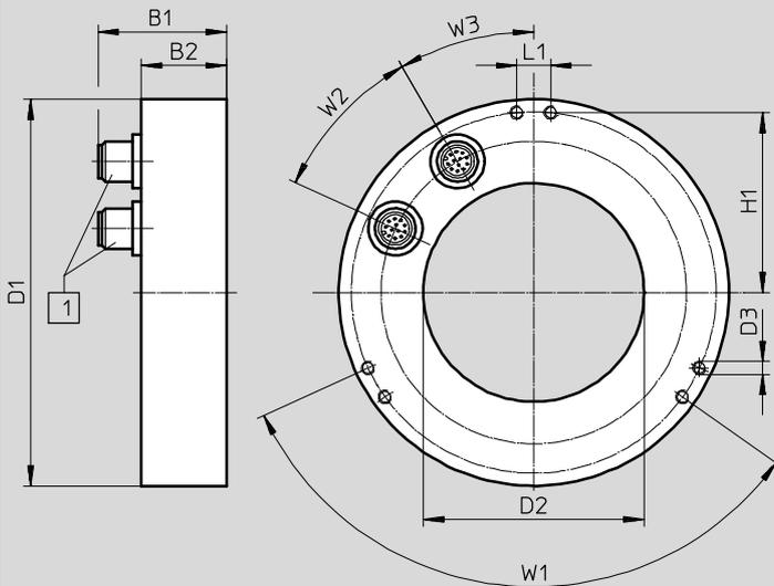
1 Conector tipo clavija M12 de 12 contactos
