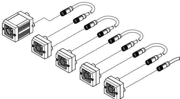
Conexión de luces anulares SBAL-C6-R al sensor de visión SBS.
