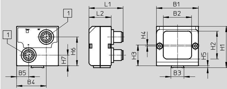
1 Conector tipo clavija M12 de 12 contactos
