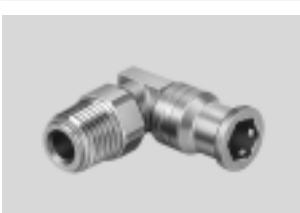
Racor rápido roscado de acero inoxidable. Máxima resistencia a la corrosión CRC4 y a substancias químicas; certificación para la industria alimentaria y del envasado. Para aplicaciones neumáticas con temperaturas de hasta 120 °C y con presiones de hasta 10 bar.
