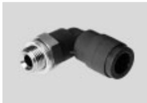
Racor rápido roscado piroretardante para la utilización en zonas con peligro de incendio, por ejemplo en equipos de soldadura en la industria automovilística o en el sector de la construcción. Para aplicaciones neumáticas con temperaturas de hasta 60 °C y con presiones de hasta 10 bar. Diámetros exteriores de los tubos flexibles de 4, 6, 8, 10 y 12 mm con rosca de conexión R1/8 ... R1/2 y G1/8 ... G1/2.
