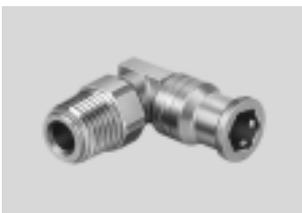
Racor rápido roscado de acero inoxidable. Máxima resistencia a la corrosión CRC4 y a sustancias químicas; certificación para la industria alimentaria y del envasado. Para aplicaciones neumáticas con temperaturas de hasta 120 °C y con presiones de hasta 10 bar. Diámetros exteriores de los tubos flexibles de 4, 6, 8, 10, 12 y 16 mm con rosca de conexión de M5 y R1/8 ... R1/2.
