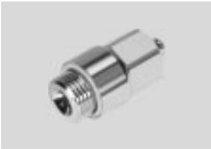
Racor de acero inoxidable para la aplicación en áreas expuestas a una limpieza intensiva. Máxima clase de resistencia a la corrosión CRC4. Para aplicaciones neumáticas con un margen de temperaturas de hasta 120 °C y con un margen de presiones de hasta 12 bar. Diámetros exteriores de los tubos flexibles de 4, 6, 8 y 10 mm con rosca de conexión M5 y G $\frac{1}{8}$  ... G $\frac{3}{8}$ .
