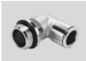
Racores metálicos de atractivo precio, para aplicaciones neumáticas con temperaturas de hasta 70 °C y con presiones de hasta 16 bar. Diámetros exteriores de los tubos flexibles de 3, 4, 6, 8, 10 y 12 y 14 mm con rosca de conexión M5, M7 y G1/8 ... G1/2.
