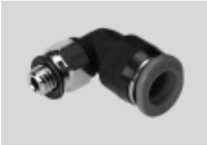
Racor rápido roscado de pequeñas dimensiones para lograr el más alto grado de integración en espacios reducidos. Para aplicaciones neumáticas con temperaturas de hasta 80 °C y con presiones de hasta 14 bar. Diámetros exteriores de los tubos flexibles de 2, 3, 4 y 6 mm con roscas de conexión M3, M5, M6, M7, R1/8 y G1/8.
