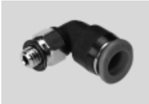
Racor rápido roscado de pequeñas dimensiones para lograr el más alto grado de integración en espacios reducidos. Para aplicaciones neumáticas con temperaturas de hasta 80 °C y con presiones de hasta 14 bar. Diámetros exteriores de los tubos flexibles de 2, 3, 4 y 6 mm con roscas de conexión M3, M5, M6, M7, R $\frac{1}{8}$  y G $\frac{1}{8}$ .
