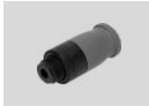
Racor de material sintético para una instalación sencilla gracias al manejo con una sola mano. Resistente a la hidrólisis, conforme con las especificaciones de la FDA y de fácil limpieza. Para aplicaciones neumáticas con temperaturas de hasta 60 °C y con presiones de hasta 10 bar. Diámetro ext. del tubo flexible de 6 mm con rosca de conexión G $\frac{1}{8}$ .
