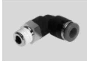
Gran selección de racores rápidos roscados para aplicaciones neumáticas con temperaturas de hasta 80 °C y con presiones de hasta 14 bar. Diámetros exteriores de los tubos flexibles de 4, 6, 8, 10, 12, 16 y 22 mm con rosca de conexión de R $\frac{1}{8}$  ... R $\frac{1}{2}$  y G $\frac{1}{8}$  ... G $\frac{3}{4}$ .
