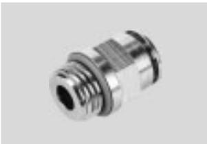
Racor metálico de latón, niquelado químico. Gran resistencia a la corrosión CRC3 y a sustancias químicas. Para aplicaciones neumáticas con temperaturas de hasta 150 °C y con presiones de hasta 20 bar. Diámetros exteriores de los tubos flexibles de 4, 6, 8, 10 y 12 y 14 mm con rosca de conexión M5, M7 y G $\frac{1}{8}$  ... G $\frac{1}{2}$ .
