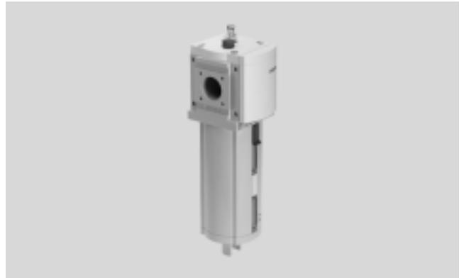
El lubricador proporcional dosifica una fina cantidad de aceite, mezclándolo con el aire a presión. La caída de presión que se produce al pasar el aire por una tobera Venturi sirve para elevar el aceite desde el
