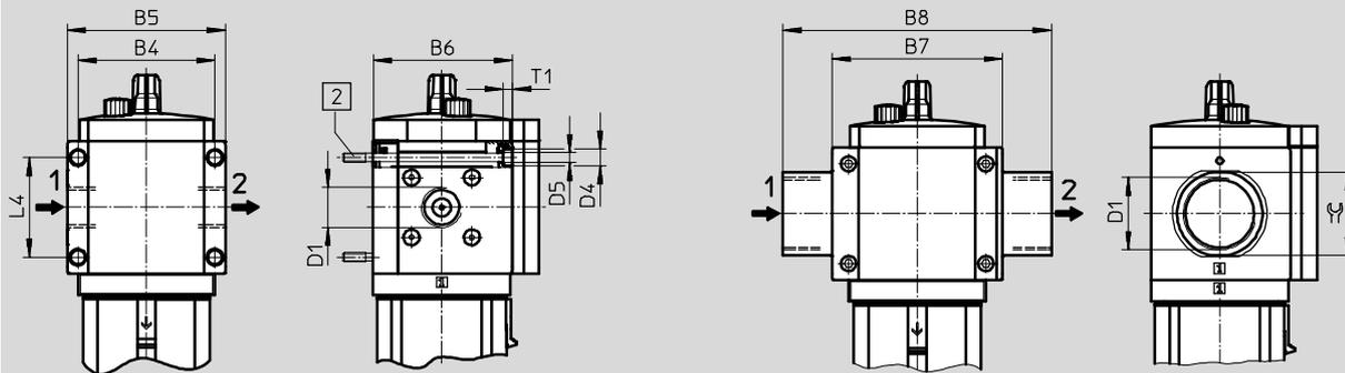
2 Tornillo M6xmin.90 según DIN 912 (no incluido en el suministro) para montaje en la pared sin escuadra de fijación
