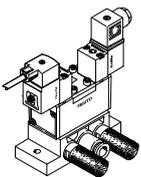
La válvula distribuidora tiene un servopilotaje según ISO 15218. La bobina enchufada al núcleo puede tener diversas formas constructivas y tensiones de funcionamiento.
