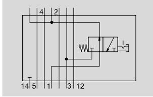
Placa vertical estranguladora de presión, para bloquear el canal 1 y el canal 14 antes de una válvula.
