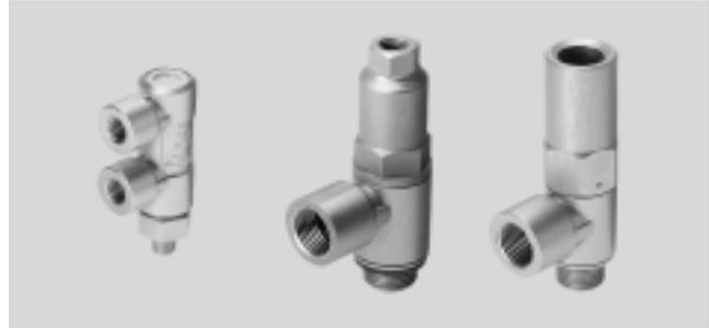
La válvula de antirretorno desbloqueable puede ser utilizada para operaciones breves de posicionamiento y frenado de actuadores neumáticos. Mientras la válvula reciba una señal en la conexión neumática 21, el aire
