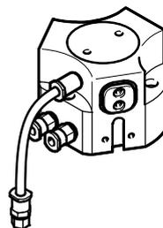
Si la pinza se utiliza en entornos húmedos o si se emplean fluidos líquidos o gaseosos, deberá ponerse cuidado en que el filtro se encuentre en un entorno neutral. Lo mismo se aplica en relación con las conexiones de aire comprimido no utilizadas, cuando la pinza se utiliza como pinza de simple efecto.
