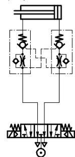
La combinación de las funciones consiste en la combinación de una válvula antirretorno y una válvula antirretorno desbloqueable. Mientras está aplicada la señal proveniente de la conexión neumática 21, se estrangula el escape. Si la válvula no recibe señal de pilotaje, bloquea el escape. En el sentido del caudal, al aire comprimido fluye a través a través de la válvula antirretorno sin estrangulación.
