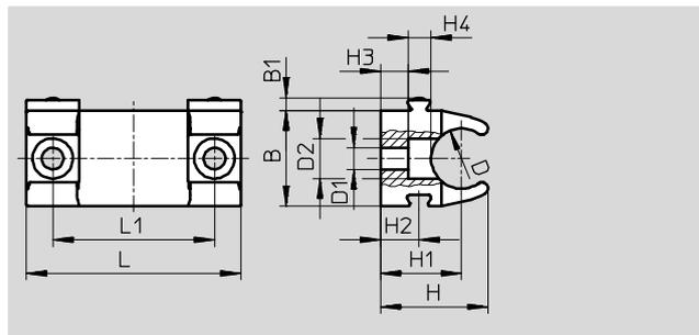
Encadenamiento de varios elementos de montaje mediante ranura de cola de milano de milano
