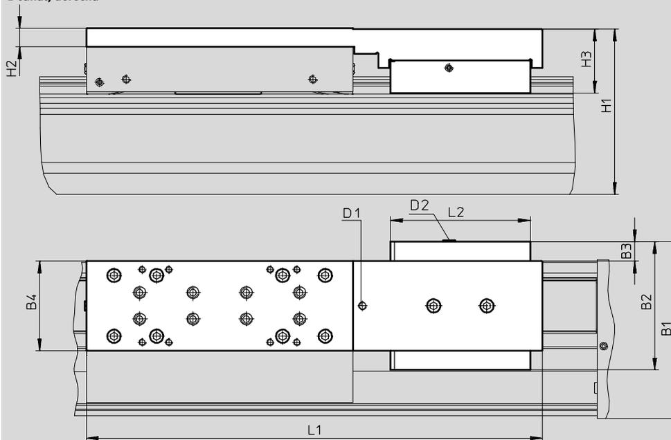
D2 Conexión de aire comprimido
