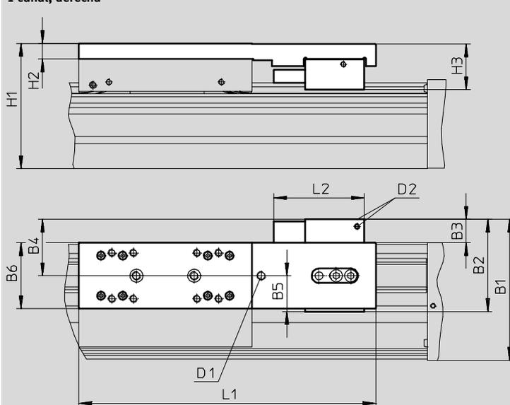
D2 Conexión de aire comprimido
