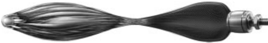
El músculo neumático es un actuador de tracción que imita la musculatura humana. Está compuesto por un tubo flexible contráctil y los empalmes. El tubo flexible contráctil está compuesto por una membrana de goma y un tejido interno de hilos de aramida. La membrana encierra herméticamente el medio de funcionamiento. Los hilos contribuyen a la robustez y a la transmisión de
