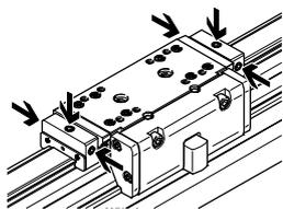
El adaptador de lubricación permite una lubricación permanente de la guía del actuador lineal DGCI mediante sistemas de lubricación automáticos o semiautomáticos, en aplicaciones expuestas a humedad. El adaptador es apropiado para aceites y grasas.
