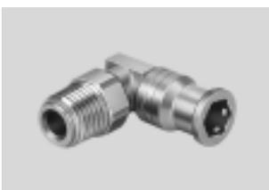
Racor rápido roscado de acero inoxidable. Máxima resistencia a la corrosión CRC4 y a sustancias químicas; certificación para la industria alimentaria y del envasado. Para aplicaciones neumáticas con temperaturas de hasta 120 °C y con presiones de hasta 10 bar. Diámetros exteriores de los tubos flexibles de 4, 6, 8, 10, 12 y 16 mm con rosca de conexión de M5 y R $\frac{1}{8}$  ... R $\frac{1}{2}$ .
