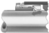
La garra de acero inoxidable sujeta el tubo flexible sin dañar su superficie. El sistema resiste las vibraciones y los picos de presión.
