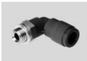
Racor rápido roscado piroretardante para la utilización en zonas con peligro de incendio, por ejemplo en equipos de soldadura en la industria automovilística o en el sector de la construcción. Para aplicaciones neumáticas con temperaturas de hasta 60 °C y con presiones de hasta 10 bar. Diámetros exteriores de los tubos flexibles de 4, 6, 8, 10 y 12 mm con rosca de conexión R $\frac{1}{8}$  ... R $\frac{1}{2}$  y G $\frac{1}{8}$  ... G $\frac{1}{2}$ .
