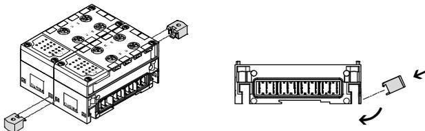
Tratándose de terminales de válvulas más largos, puede recurrirse a elementos de fijación adicionales para el terminal CPX que puede colocarse entre dos módulos.
