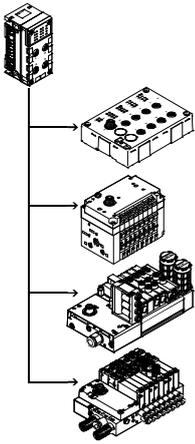
La conexión eléctrica CPX-CTEL-Master establece una conexión con los módulos con interfaz I-Port de la gama CTEL/CTEU. Los datos E/S de las unidades conectadas se transmiten a los nodos de bus CPX y, por lo tanto, a la unidad de control superior a través del bus de campo. Mediante interfaces M12 correspondientes, es posible conectar máximo 4 unidades a un master CPX-CTEL.
