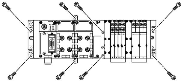
Las placas finales del terminal CPX, del terminal de válvulas y de la conexión neumática están provistas de taladros para el montaje mural. Si los terminales de válvulas son más largos, puede recurrirse a los elementos de fijación adicionales para el terminal CPX. Estas fijaciones se diferencian entre sí según la versión del terminal CPX (material sintético o metal)
