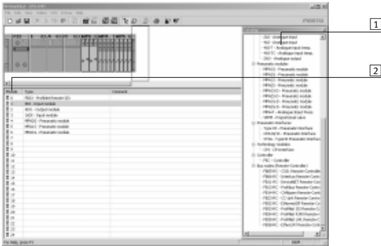
La configuración puede crearse, parametrizarse y guardarse de modo sencillo con la función de arrastrar y soltar. Es posible incluir y desplazar módulos.
