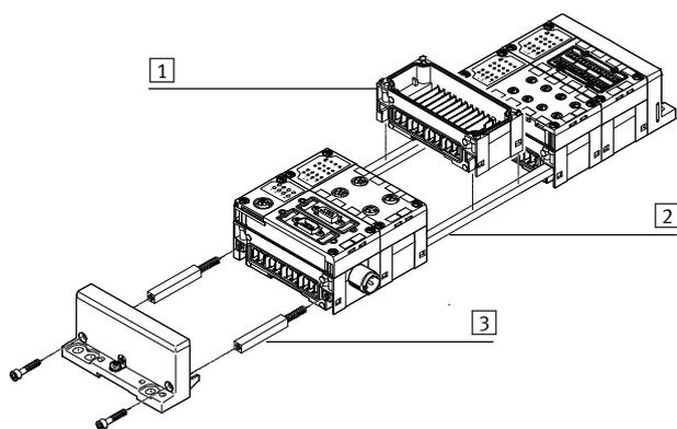
Los módulos CPX se unen entre sí mecánicamente mediante tirantes **2** especiales. Toda la unidad de monta utilizando únicamente dos tornillos en las placas finales.
