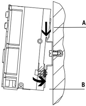
En el perfil trasero de los bloques de distribución CPX se encuentra el sistema de montaje en perfil DIN. Mediante las fijaciones para carril DIN se fija el terminal CPX al carril DIN. Para ello, el terminal CPX se engancha en el perfil DIN (ver flecha A).
