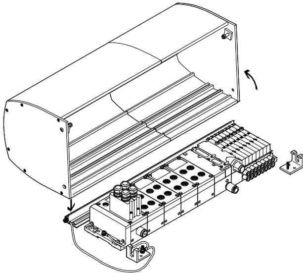
En vez de utilizar un armario de maniobra, la tapa CAFC es una alternativa que permite ahorrar espacio y reducir costos. La tapa es de aluminio extrusionado y se instala sobre una placa de montaje. La instalación es sencilla, pues se prescinde del cableado y del tendido de tubos flexibles, usuales en armarios de maniobra. Así, el terminal de válvulas (CPX con tipo MPA-S o MPA-L) está protegido fiablemente.
