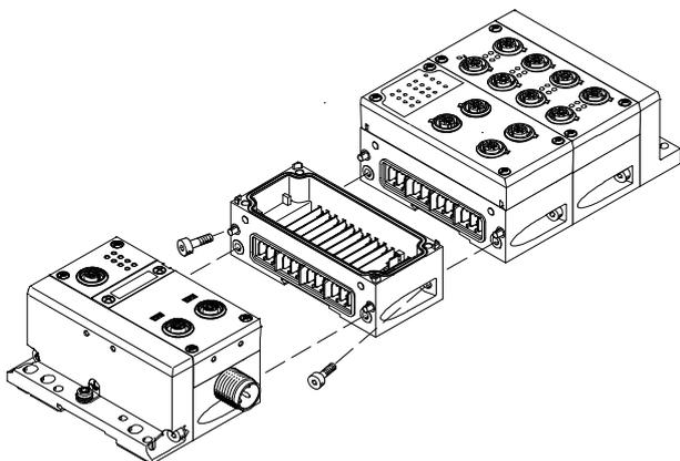
Los módulos CPX se unen entre sí mecánicamente mediante tornillos inclinados.
