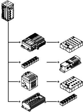
La conexión eléctrica de CPX CP-Interface establece la conexión con módulos CP del sistema de instalación CPI mediante cables prefabricados. Las señales E/S de los terminales de válvulas conectados y con ampliación CP del ramal y módulos CP de entradas y salidas se transmiten al nodo de bus CPX conectado y, por lo tanto, a la unidad de control de nivel superior a través de bus de campo. De esta manera es posible crear sistemas centralizados y descentralizados compactos en un solo sistema.
