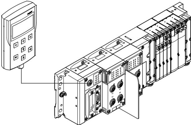
La unidad de indicación y control se conecta al terminal CPX-P mediante un cable preconfigurado.
