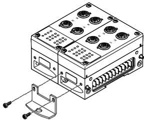
Tratándose de terminales de válvulas más largos, puede recurrirse a escuadras de fijación para el terminal CPX-P que se atornillan a los bloques de distribución.
