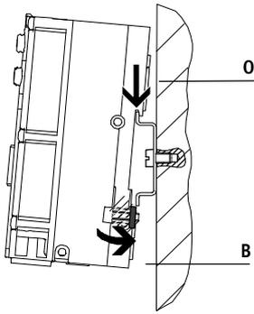
Perfil DIN en la parte posterior de los módulos CPX-P. El terminal CPX-P puede montarse fijamente al perfil DIN. El terminal CPX-P se cuelga en el perfil DIN (ver flecha A). A continuación se gira el terminal y se
