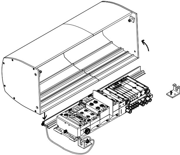
En vez de utilizar un armario de maniobra, la tapa CAFC es una alternativa que permite ahorrar espacio y reducir costos. La tapa es de aluminio extrusionado y se instala sobre una placa de montaje. La instalación es sencilla, pues se prescinde del cableado y del tendido de tubos flexibles, usuales en armarios de maniobra. Así, el terminal de válvulas está protegido fiablemente.
