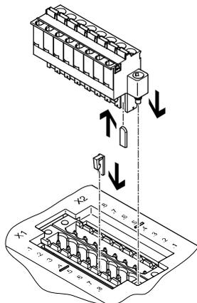
Las placas de alimentación CPX-P-AB-2XKL-8POL, CPX-P-AB-2XKL-8POL-8DE-N-IS y los conectores tipo zócalo NECU-L3G8 tienen conexiones inconfundibles CPX-P-KDS-AB-2XKL.
