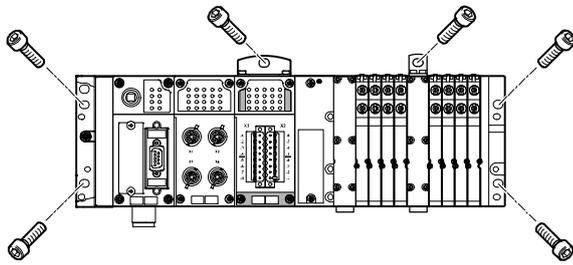
Las placas finales del terminal CPX-P, del terminal de válvulas y de la interface neumática están provistas de taladros para el montaje en la pared. Si los terminales de válvulas son más largos, puede recurrirse a los elementos de fijación adicionales para el terminal CPX-P.
