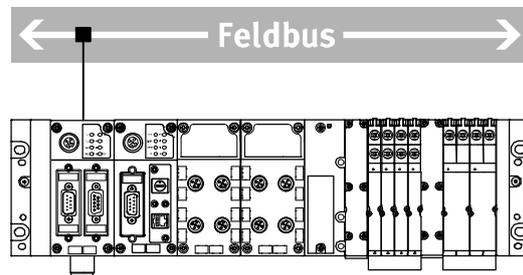
Plataforma CODESYS V3 suministrada por Festo, para el mejor terminal de válvulas disponible: CPX-CEC como terminal I/O remoto inteligente, con clase IP65/IP67 en la máquina, para reducir los costes originados por el trabajo de instalación.
