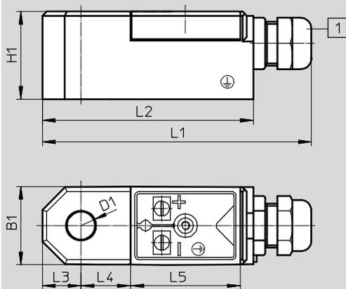
1 Klemmenkasten, Kabeleinführungsgewinde M20x1,5
