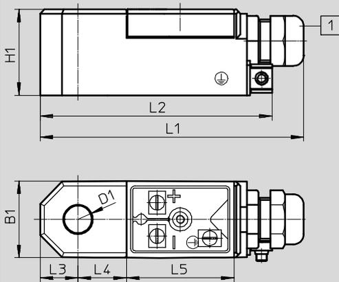
1 Klemmenkasten, Kabeleinführungsgewinde M20x1,5
