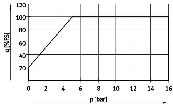
1) Ab einem Betriebsdruck von 5 bar können vom Durchflusssensor Messwerte mit der spezifizierten Genauigkeit über den vollen Messbereich ermittelt werden. Bei einem Betriebsdruck unter 5 bar verringert sich der Messbereich mit spezifizierter Genauigkeit wie im Diagramm dargestellt.
