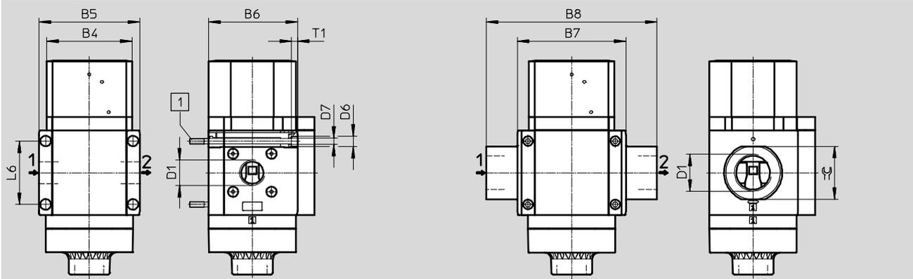
1 Befestigungsschraube M6xmin.90 nach DIN 912 (nicht im Lieferumfang enthalten) zur Wandmontage ohne Befestigungswinkel
