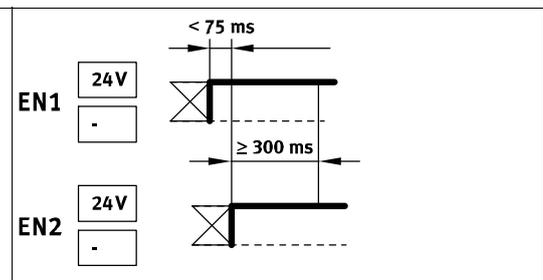
– Taktende Enable-Signale (EN1 = 0 ... 24 V, EN2 = 0 ... 24 V) zur Querschlusserkennung.
