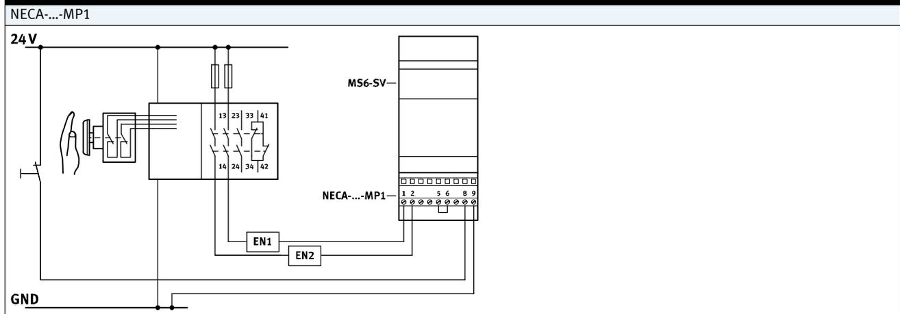
– Statische Enable-Signale (EN1 = 24 V, EN2 = 24 V).
