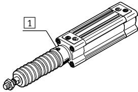
Der Faltenbalgbausatz ist ein leakage-freies System. Um das Ansaugen von unerwünschten Medien zu vermeiden, ist die Zu- bzw. Abluft des Bausatzes über eine Druckausgleichsöffnung im Anbinde-
