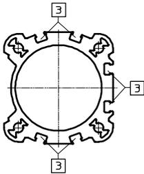
Durch Auswahl des Merkmals D3 im Produktbaukasten kann die Kolbenposition an 3 Seiten des Antriebs abgefragt werden.
