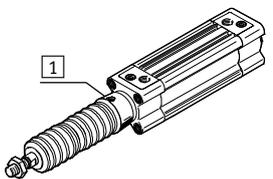
Durch den Faltenbalg werden Kolbenstange, Dichtung und Lager vor dem Einwirken unterschiedlichster Medien geschützt, was sich positiv auf dessen Lebensdauer auswirkt.
