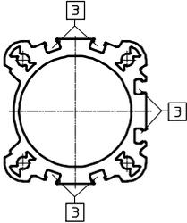
Bei dieser Ausführung kann die Kolbenposition an 3 Seiten des Antriebs abgefragt werden.
