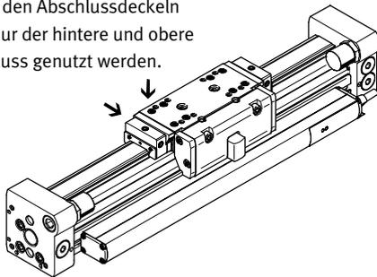
In Verbindung mit Stoßdämpferhalter DADP kann nur der vordere und obere Anschluss genutzt werden.
