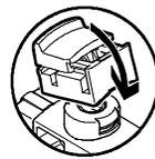
旋转手控装置, 卡扣到先导阀上。
