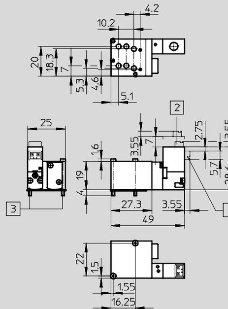
1 Raccordement électrique par l'arrière
