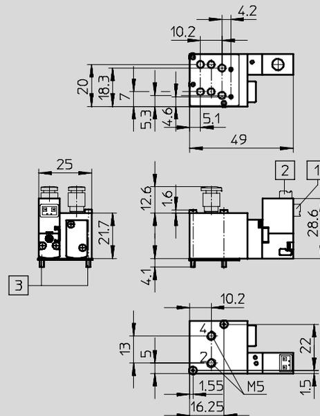
1 Raccordement électrique par l'arrière
