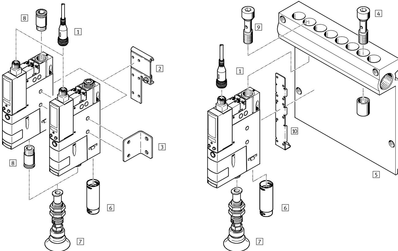
1) Une vis creuse 9) et une équerre de fixation 10) sont fournies avec l'OVEM-...-PL/PO-...
