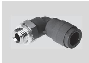
Raccord enfichable ignifugé, destiné à toutes les applications comportant des risques d'incendie (par exemple, les installations de soudage dans l'industrie automobile ou la construction en bâtiment). Pour les applications pneumatiques avec une plage de température allant jusqu'à 60 °C et une plage de pression allant jusqu'à 10 bar.
