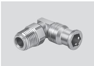
Raccord enfichable en acier inoxydable. Résistance extrême à la corrosion CRC4 et aux produits chimiques et homologation pour l'industrie agroalimentaire, ainsi que pour celle de l'emballage. Pour les applications pneumatiques avec une plage de température allant jusqu'à 120 °C et une plage de pression allant jusqu'à 10 bar.
