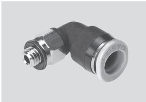
Raccord enfichable de petit format pour une étanchéité élevée et un encombrement faible. Pour des fonctions essentielles en pneumatique avec une plage de température allant jusqu'à 60 °C et une plage de pression allant jusqu'à 10 bar.
