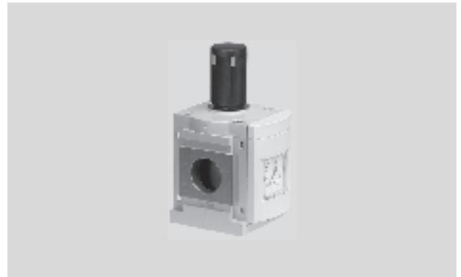
Le manodétendeur maintient la pression de sortie p2 pratiquement constante, indépendamment des variations de pression provenant du réseau et de la consommation d'air. La pression de sortie p2 se règle (dans les limites de la plage de réglage de la pression) de trois manières : manuellement, à l'aide du bouton ; pneumatiquement,
