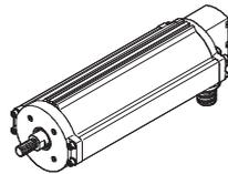
DFPI avec système de mesure, régulateur de position et terminal de distributeurs intégrés, et raccords pneumatiques protégés
