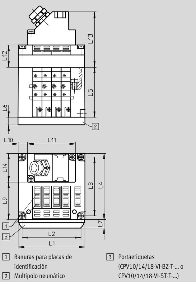
Terminal de válvulas con conexión de AS-Interface: CPV10/14/18
