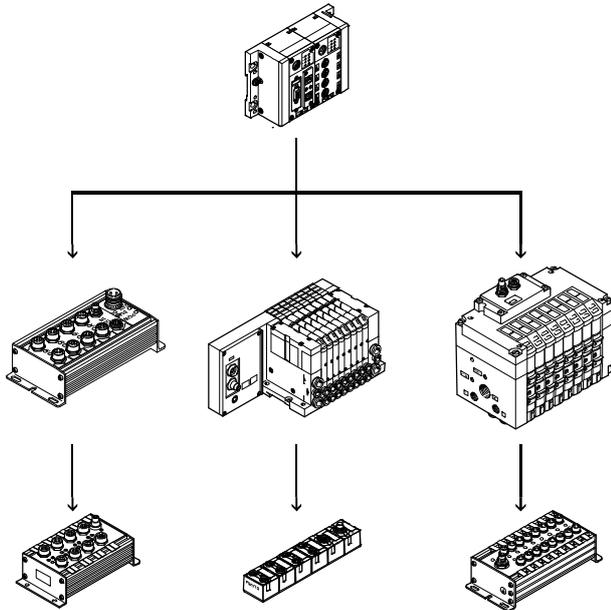
El terminal de válvulas con conexión CP puede ser conectado a nodos de bus o a bloques de mando. El nodo de bus o el bloque de mando permiten conectar unidades descentralizadas de entrada/salida. Soporta los siguientes protocolos de bus:
