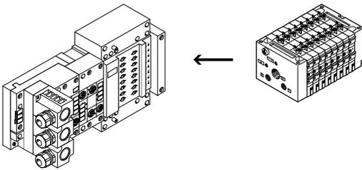
Adaptación de la batería de válvulas al módulo de entradas y salidas ET200X/ET200pro de Siemens: Combinando los módulos funcionales de la unidad ET200X/ET200pro con las funciones neumáticas de la batería de válvulas CPV se obtiene una solución de automatización altamente integrada para sistemas con actuadores eléctricos y neumáticos con:
