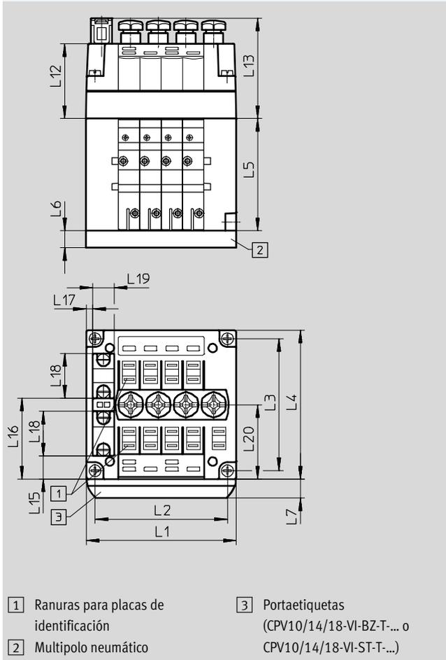
Terminal de válvulas con conexión de AS-Interface y entradas adicionales CPV10
