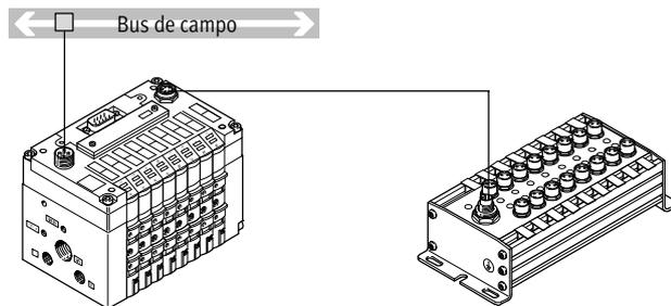
El bus de campo Direct es un sistema compacto para la conexión de un terminal de válvulas CPV o CPV-SC a diversos estándares de bus de campo, como por ejemplo PROFIBUS y DeviceNet.
