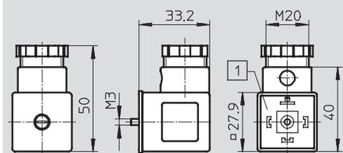
1 Patrón de conexiones según EN 175301-803 forma A
