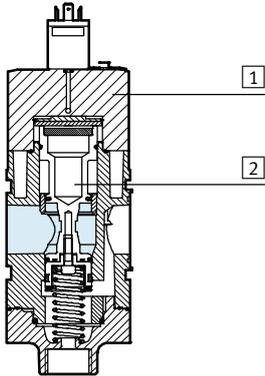
Válvula de arranque progresivo y de escape
