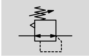
El regulador de presión permite ajustar manualmente una presión determinada en la conexión regulada antes o incluso después de la válvula.
