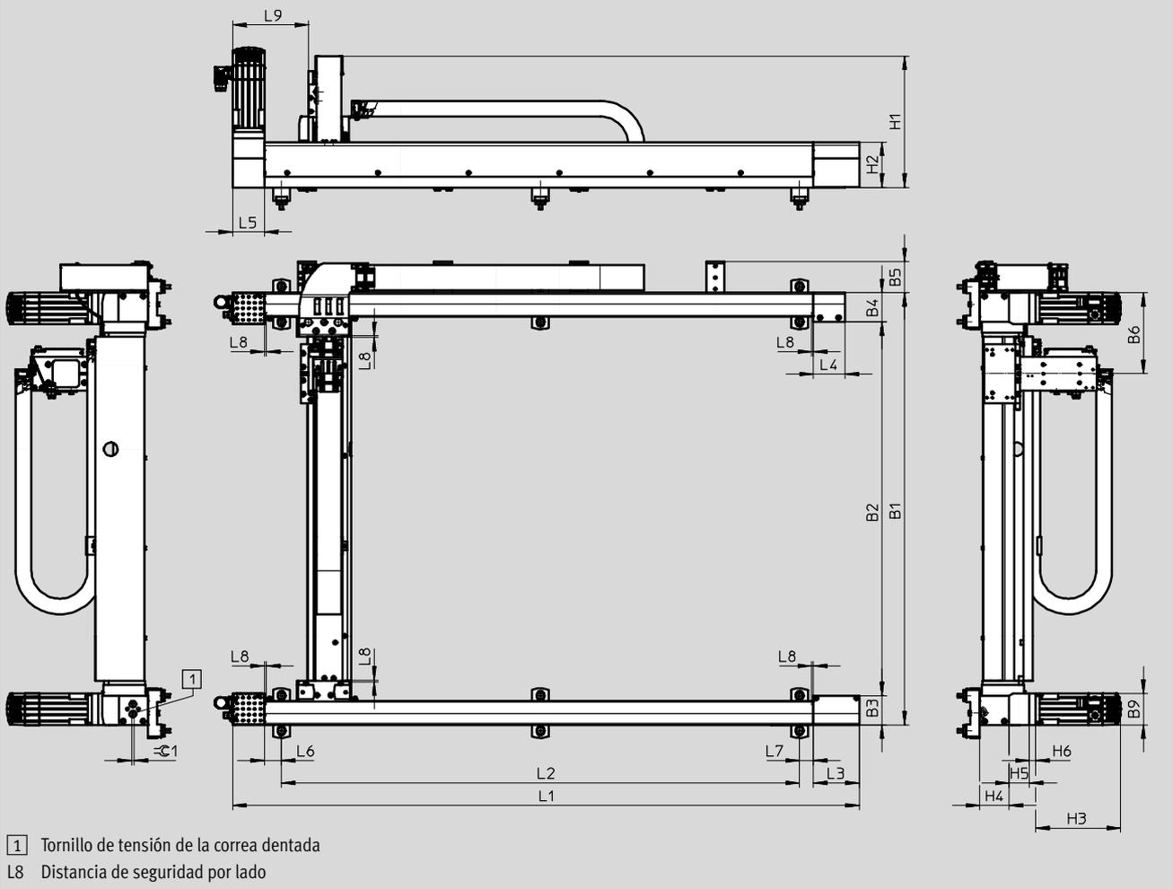
EXCH-40-...-B – Posición de montaje inferior del motor
