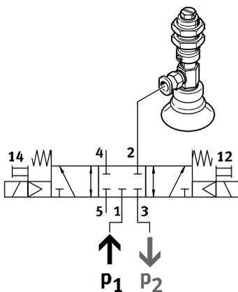
Vakuum, Abwurfimpuls und Ruhestellung mit interner Steuerluft können realisiert werden, indem an Kanal 3 Vakuum und an Kanal 1 Druck für den Abwurfimpuls angeschlossen wird.
