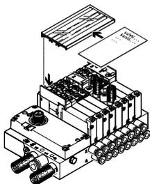
Schilderträger ASCF-H-L1... zur Kennzeichnung der Ventile der Ventilinsel VTUG.
