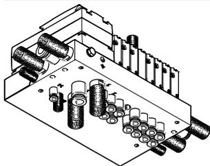
Für Anschlussplattenventile M5/M7 (Ventilgröße 10 mm)
