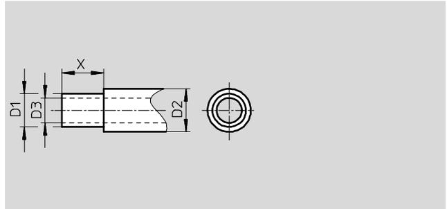
Bevor der Kunststoffschlauch PAN-V0 in die Steckverschraubung QS-V0 gesteckt werden kann, muss die PVC-Ummantelung des Schlauchs um das Maß X
