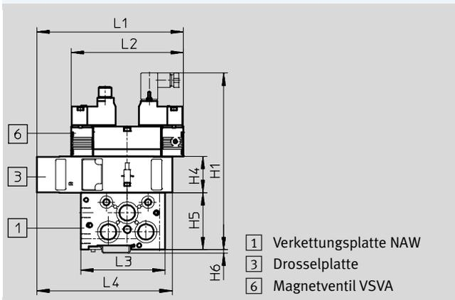
Baubreite 26 mm mit Verkettungsplatte und Magnetventil mit Zentralstecker
