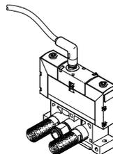
Der elektrische Anschluss erfolgt über eine genormte M12- oder M8-Steckdose 24 V DC (EN 61076-2-101).
