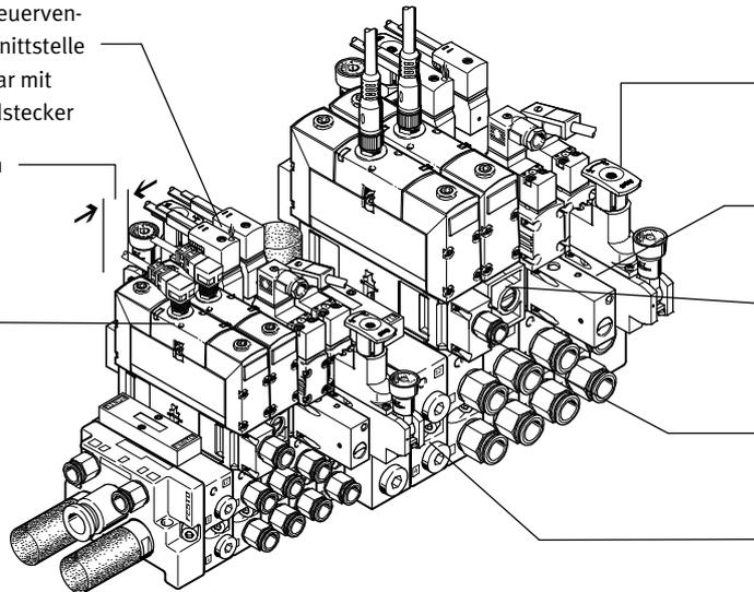
Druckregelventil zum Einstellen der Kraft des angeordneten Antriebs
