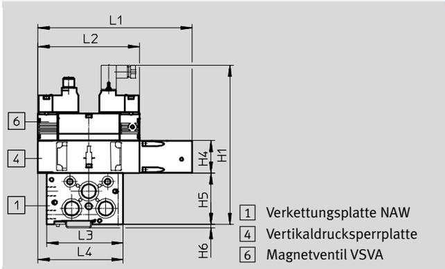
Baubreite 26 mm mit Verkettungsplatte und Magnetventil mit Zentralstecker
