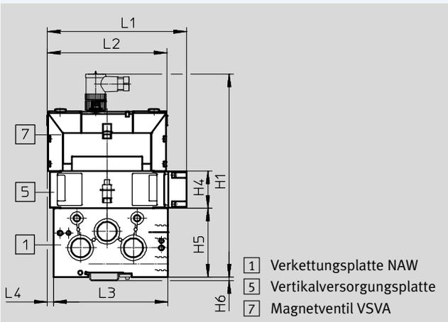
Baubreite 26 mm mit Verkettungsplatte und Magnetventil mit Vorsteuerschnittstelle nach ISO 15218
