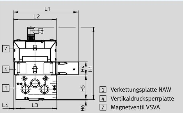
Baubreite 26 mm mit Verkettungsplatte und Magnetventil mit Vorsteuerschnittstelle nach ISO 15218
