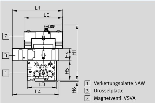
Baubreite 18 mm mit Verkettungsplatte und Magnetventil mit Vorsteuerschnittstelle nach ISO 15218
