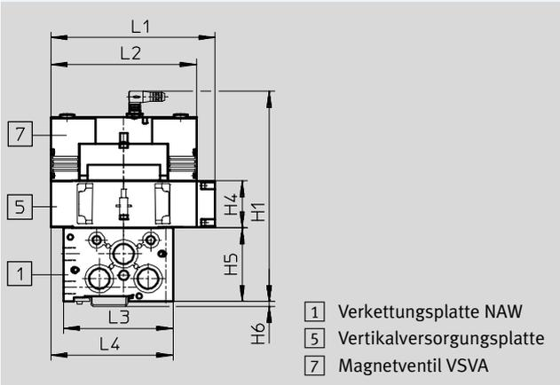
Baubreite 18 mm mit Verkettungsplatte und Magnetventil mit Vorsteuerschnittstelle nach ISO 15218
