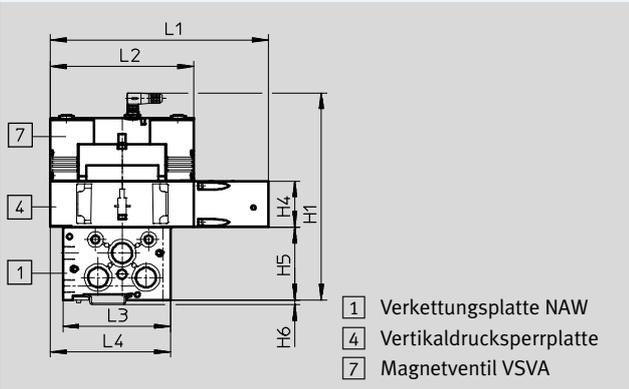
Baubreite 18 mm mit Verkettungsplatte und Magnetventil mit Vorsteuerschnittstelle nach ISO 15218
